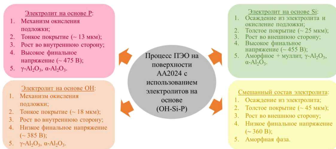
Рисунок 37 - Схематическая иллюстрация характеристик покрытий ПЭО, полученных в различных составах электролитов [181, с. 18]
